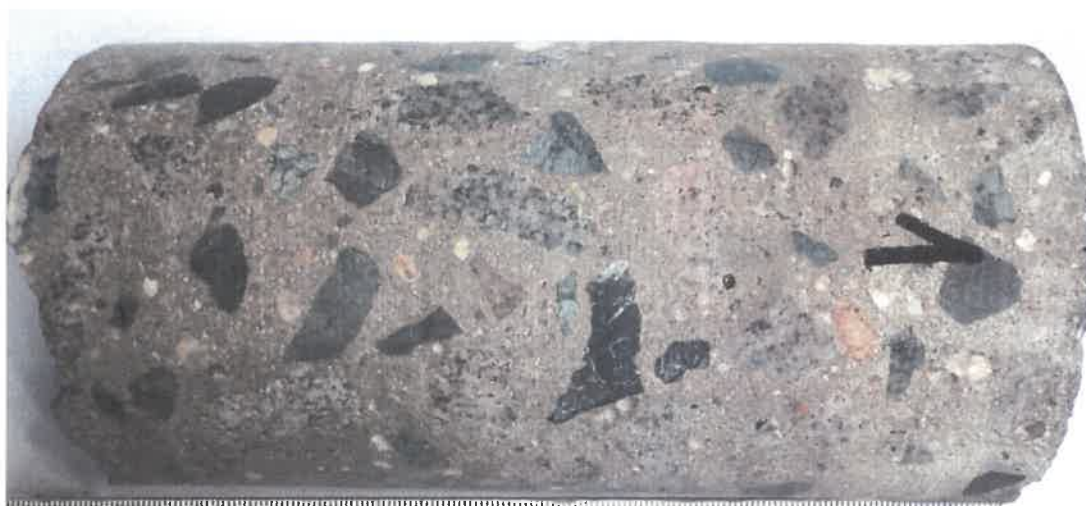
Vývrt V1 - nosná konstrukce, střední pole
